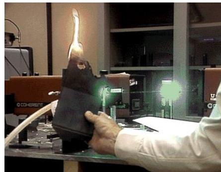
그림 9-9. 레이저에 의한 화재 위험
